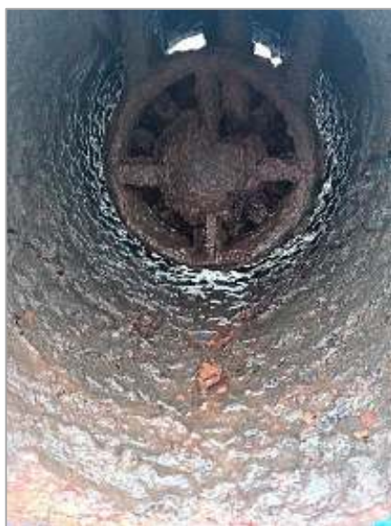
10. kép. Parti szűrésű vízműkútból kiépített szerelvény vas- és mangán csapadékkal borított belső felülete (Forrás: BÁC SVÍZ Zrt.) Photo 10. Inner surface of a removed kit from a bank-filtered water well coated with iron and manganese precipitation (Source: BÁC SVÍZ Zrt.)
