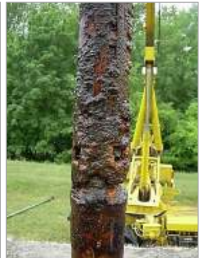
8. és 9. kép. Vas- és mangán-oxid csapadék a kútból kiépített búvárszivattyún (Forrás: BÁC SVÍZ Zrt.) Photo 8 and 9. Iron and manganese oxide precipitation on a submersible pump removed from a well (Source: BÁC SVÍZ Zrt.)
