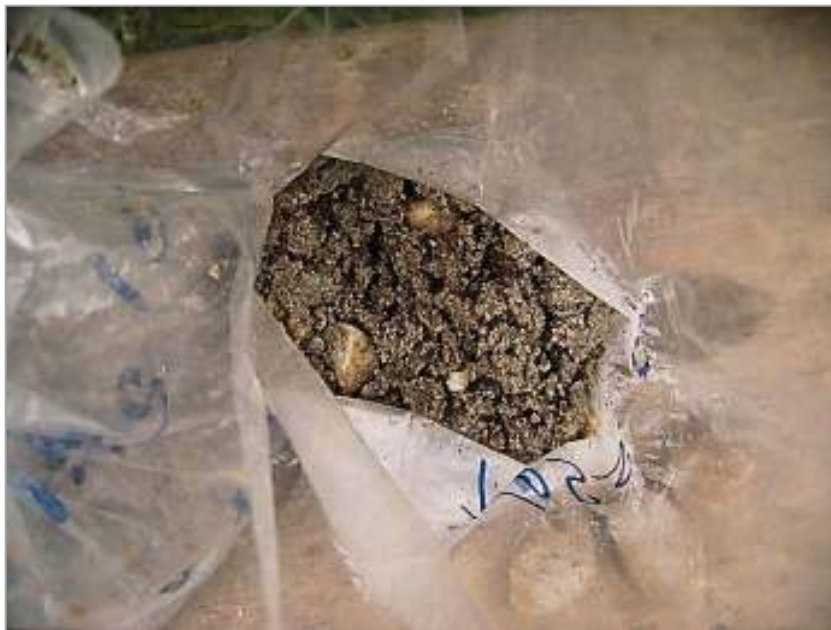
4. kép. A termeltetett vízadó réteg jellemző szemszerkezete a T-15. jelű kút szelvényében 2014-ben Picture 4. The typical grainsize structure of the production aquifer in the T-15 well section in 2014
